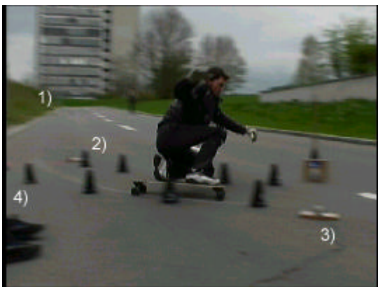
Abb.22): 1) Start 1 2) Start 2 Lichtschranke 3) Ziel Lichtschranke 4) Messgerät
